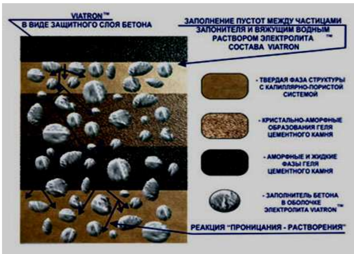
Рис. 1 Схема взаимодействия VIATRONA с бетоном
